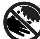
**SIERRA HACIA ABAJO Y ESPERE A QUE SE DETENGA ANTES DE MOVER LAS MANOS, LA PIEZA DE TRABAJO O CAMBIAR LOS AJUSTES.
