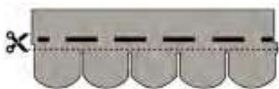
Fig. 2 - Corte das telhas
